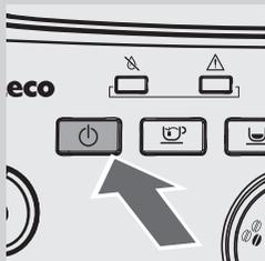
**13** Auf dem Bedienfeld blinkt die Taste "⏻". Die Taste "⏻" drücken, um die Maschine einzuschalten.
