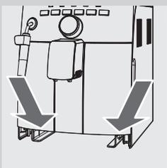
Die Aufnahme der Abtropfschale reinigen.
