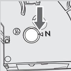
8 Sicherstellen, dass sich die Brühgruppe in der Ruhestellung befindet; die zwei Bezugspunkte müssen übereinstimmen. Im gegenteiligen Falle den unter Punkt (9) beschriebenen Vorgang ausführen.
