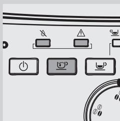
**14** Die LED "⚠" "⚠" und die LED der Taste "⏻" beginnen, mit kurzen Intervallen zu blinken, und zeigen damit an, dass das Wassersystem entlüftet werden muss.
