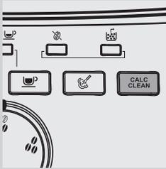
Während der Benutzung bilden sich im Inneren der Maschine Kalkablagerungen, die regelmäßig entfernt werden müssen. Im gegenteiligen Falle kann es im Wasser- und Kaffeesystem zu Verstopfungen kommen. Die Maschine zeigt an, wann die Entkalkung erforderlich ist. Leuchtet die LED "CALC CLEAN" dauerhaft auf, so bedeutet dies, dass die Entkalkung durchgeführt werden muss.
