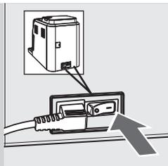
**12** Den Hauptschalter auf der Rückseite der Maschine in Position "I" stellen.
