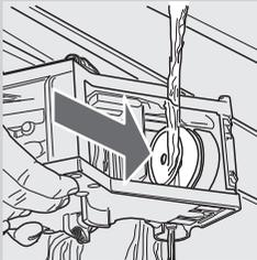
5 Die Brühgruppe mit lauwarmem Wasser reinigen. Den oberen Filter sorgfältig reinigen.
