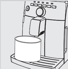
**10** Den Wassertank herausnehmen, ausspülen und bis zum Füllstand MAX mit frischem Wasser füllen. Wieder in die Maschine einsetzen.
