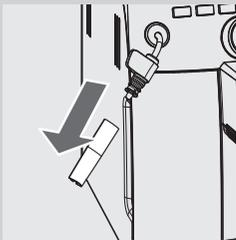
Den äußeren Teil des Pannarello entfernen und mit frischem Wasser reinigen.
