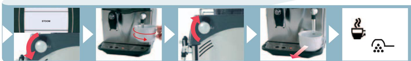
Draai de knop open voor de afgifte van stoom. Het apparaat duidt de functie aan.
