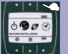
Met de "ESC" toets verlaat u de programmering zonder wijzigingen door te voeren.
