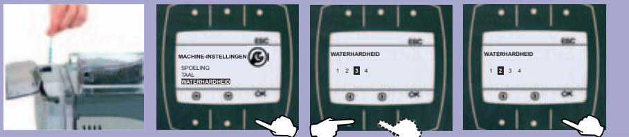
De hardheid van het water in het apparaat dient geregeld te worden al naargelang de hoeveelheid kalk en de graad van hardheid van het water.
