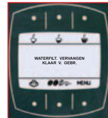
Vervang zo snel mogelijk het "Aqua Prima" filter. Heeft u geen nieuw filter dan verwijdert u het aanwezige filter en schakelt u de functie "Waterfilter" uit (zie programmering).
