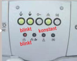
Die Maschine zeigt an, dass die Leitungen befüllt werden müssen.
